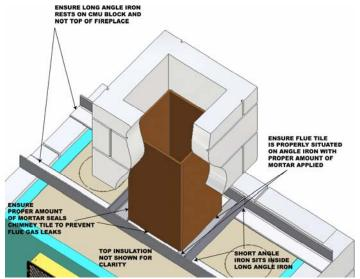
FIGURE 7A: MASONRY CHIMNEY INSTALLATION
